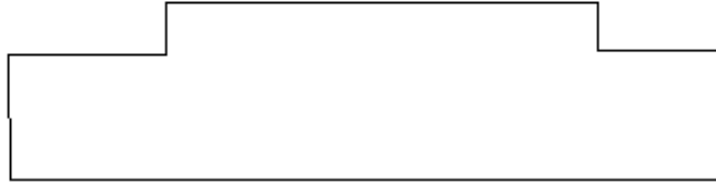
Figur 21.14. Du laver en skitse med løs hånd, som viser det halve af akslen, som hvis den var gennemskåret. Vælg derpå Profil-knappen og udpeg hele skitsen.
